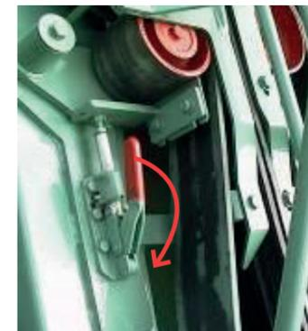
Un tendeur de courroie permet de donner la souplesse nécessaire à une remise en place simple et facile. La tension bien contrôlée assure une bonne motricité des courroies extérieures, indispensable pour réaliser un arrachage de qualité.
