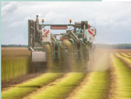
En déposant le lin près du sol, les doubles courroies permettent de limiter les effets du roulis et du tangage responsables des paquets et des sinusoïdes.
