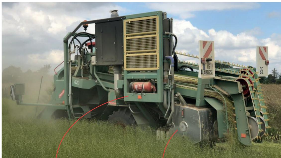
Depuis 2017, l'arracheuse est équipée d'un nouveau moteur refroidi eau de 160 kW. un groupe de refroidissement puissant, avec inversion de sens, maintient les équilibres thermiques.
