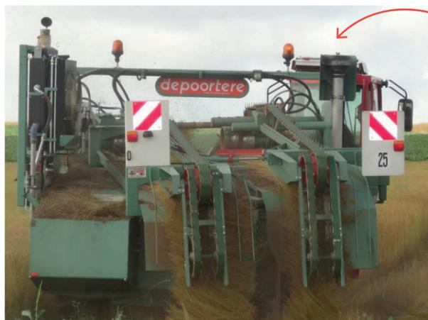
L'admission d'air moteur est protégée par un préfiltre cyclonique placé derrière la cabine.
