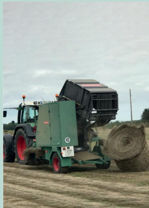
Lorsque le diamètre souhaité est atteint, le liage s'effectue automatiquement à partir d'une impulsion donnée par le chauffeur : accélération la cage, positionnement des ficelles, coupures, ouverture et fermeture de porte.
