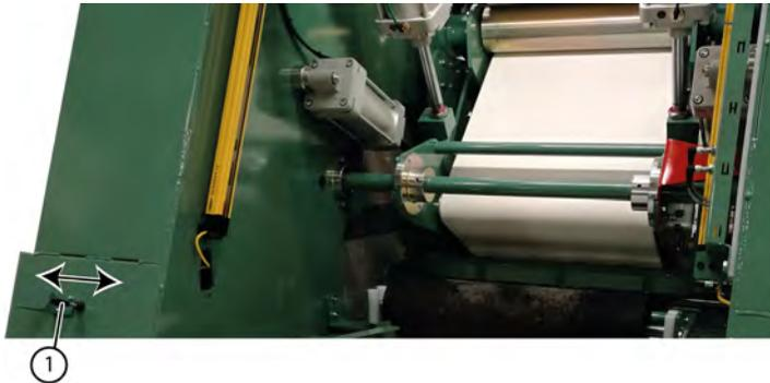
Tirez ou poussez le levier (1) dans la direction dans laquelle l'enrouleur doit se déplacer.
