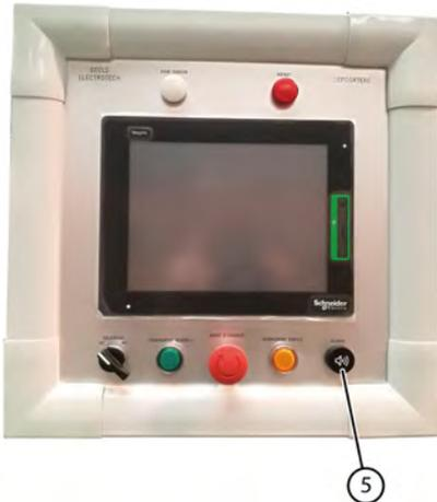
Fig. 27: Buzzer sur l'écran de commande
