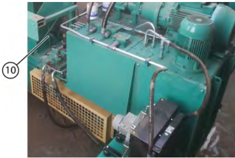
Fig. 13: Détecteur de l'acheminement du lin
